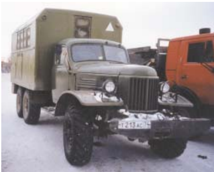
Автомобиль ЗИЛ-157КГ с лебедкой, кузовом-фургоном и экранированным электрооборудованием. Хорошо видны телескопические амортизаторы спереди. Фото В.Дмитриева
