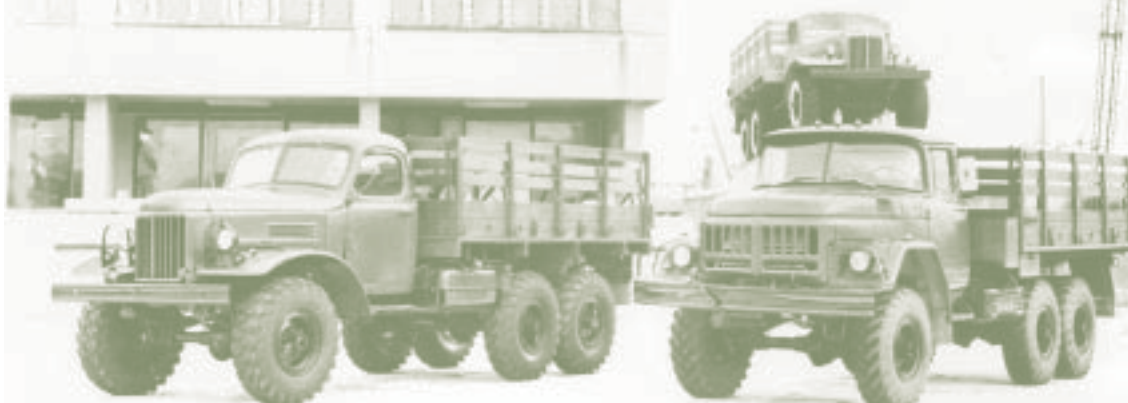
Автомобиль ЗИЛ-157КД с новой платформой армейского типа. На переднем плане справа опытный образец ЗИЛ-157КД с кабиной и платформой от ЗиЛ-131Н. Обратите внимание на колёса и ведущие мосты. На заднем плане первый автомобиль ЗИЛ-157К, воздвигнутый на постамент возле проходной Уральского автомоторного завода
