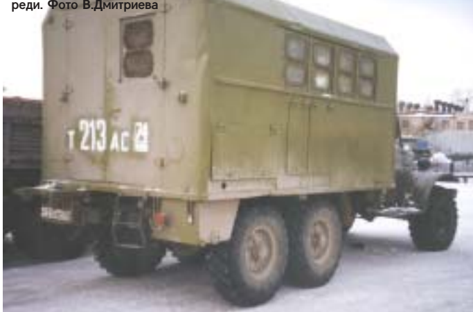
Автомобиль ЗИЛ-157КГ с лебедкой, кузовом-фургоном и экранированным электрооборудованием. Хорошо видны телескопические амортизаторы спереди. Фото В.Дмитриева
