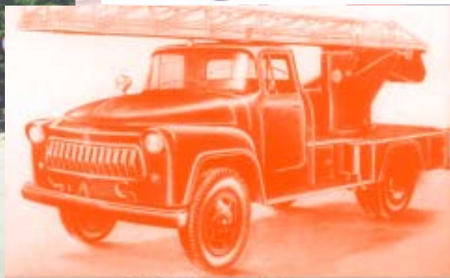
Автолестница АЛГ-18(52) высотой 18 м с гидроприводом.
