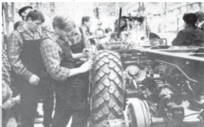
Сборка первого автомобиля ЗиЛ-157К на Уральском автомоторном заводе 27 ноября 1977 г. Монтаж колёс с шинами модели К-70 на шасси автомобиля. Хорошо различимы тормозные камеры и подвески задних мостов
