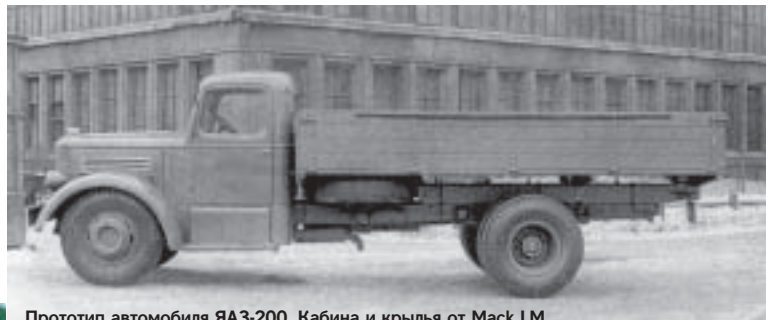
Прототип автомобиля ЯАЗ-200. Кабина и крылья от Mack LM. Москва, 1948 г. Фото из архива Л. Сусливичуса
